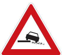
A 28 Nebezpečná krajnice
