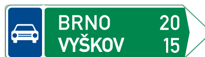
IS 2d Směrová tabule pro příjezd k silnici pro motorová vozidla (s dvěma cíli)
