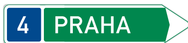
IS 2c Směrová tabule pro příjezd k silnici pro motorová vozidla (s jedním cílem)
