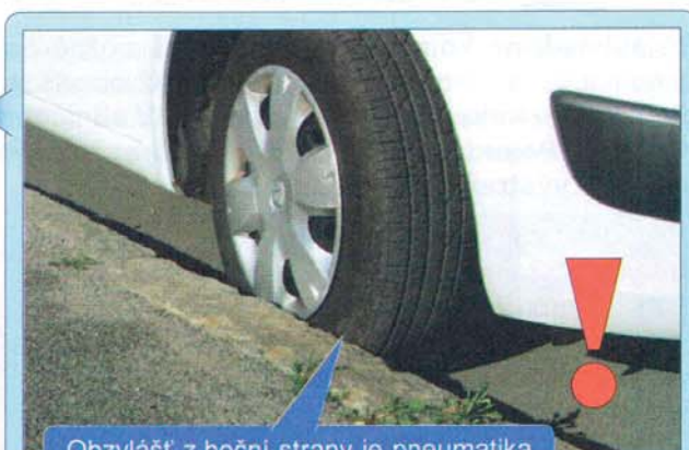
Obzvláště z boční strany je pneumatika náchylná na poškození.
